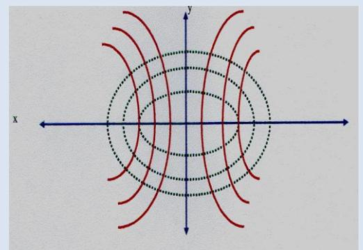
Según lo expuesto, la ecuación  $f(x, y, c) = 0$  representa la solución general de una ecuación diferencial. Esta puede obtenerse eliminando el parámetro c del sistema formado por  $f(x, y, c) = 0$  y la derivada de  $f(x, y, c) = 0$  respecto de las variables independientes (en este caso x).
